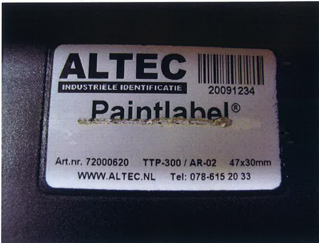
Foto 5: Detail label profiel C, direct belast, na 1000 uur zure zoutwater neveltest
