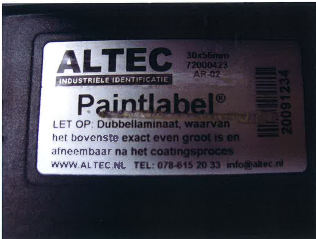
Foto 4: Detail label profiel C, direct belast, na 1000 uur zure zoutwater neveltest
