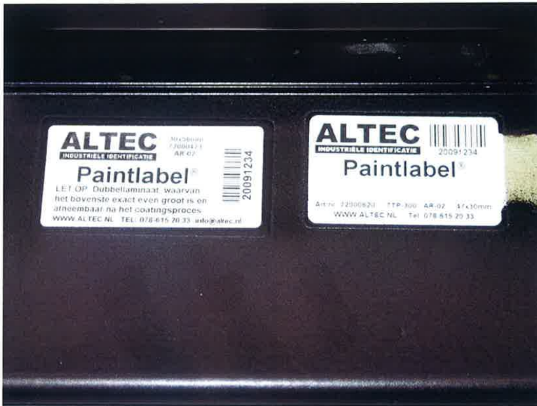
Foto 1.: Labels profiel A, indirect belast, na 1000 uur zure zoutwaterneveltest
