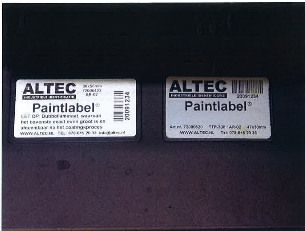
Foto 2: Labels profiel C, direct belast, na 1000 uur zure zoutwaterneveltest
