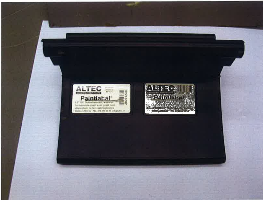
Foto 3: Labels profiel C met kras, direct belast, na 1000 uur zure zoutwater neveltest
